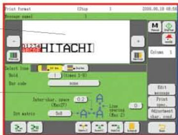
Varios parametros, tales como configuración de línea y tamaño de caracter pueden ser fácilmente ajustados en una simple pantalla.
